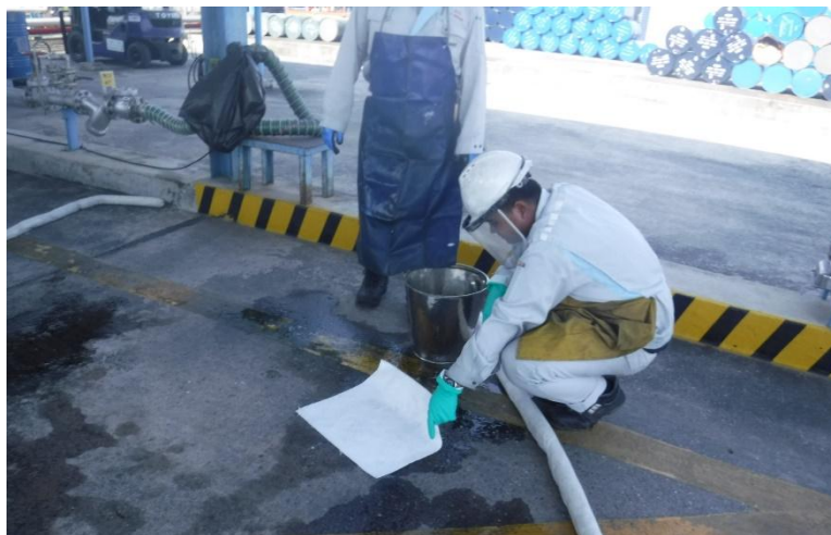
รูปที่ 2.2.3-1 การเก็บกวาดสารเคมีที่ไหลนองพื้นด้วยภาชนะที่ไม่ก่อประกายไฟลงถัง
