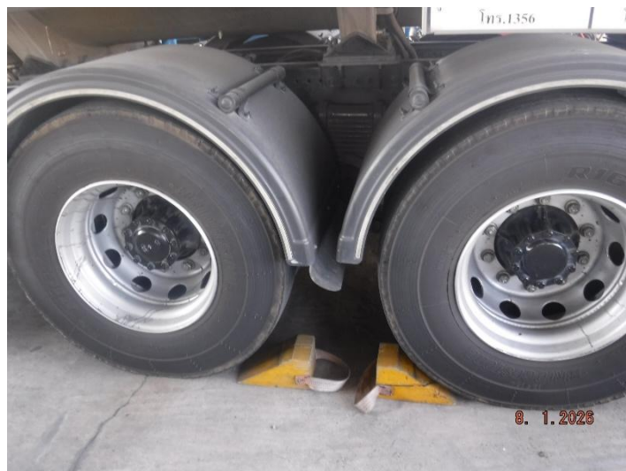
รูปที่ 2.2.2-4 การวางหมอนรองล้อ
