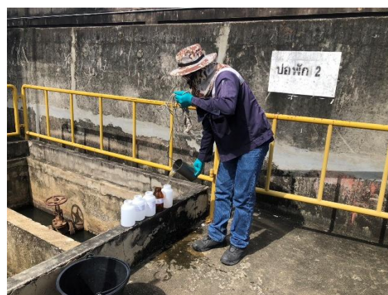
รูปที่ 3.2.1-2 วิธีการเก็บตัวอย่างน้ำทิ้งจากบ่อบำบัดหมายเลข 2
