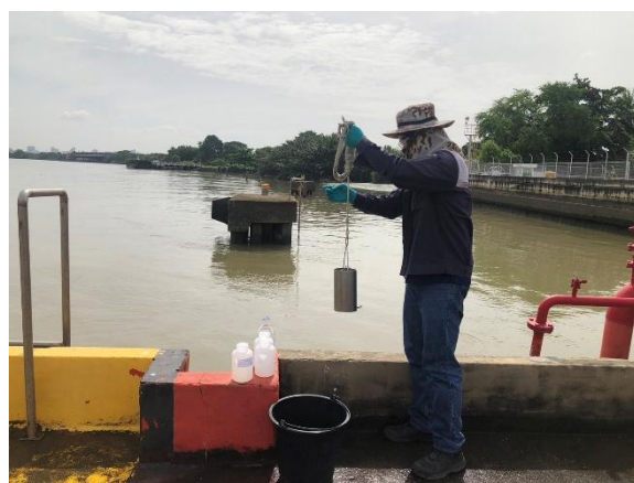
รูปที่ 3.2.1-4 วิธีการเก็บตัวอย่างน้ำในแม่น้ำที่หน้าท่าเทียบเรือ
